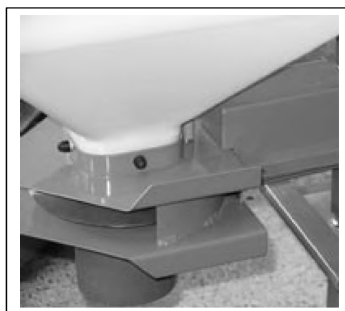
Fig. 5 KS40 stålramme med såkasse
