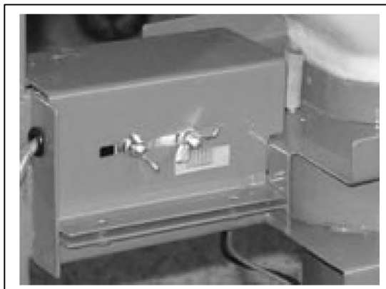
Fig. 7 KS40 – Kalibrering af glider med stepmotor
