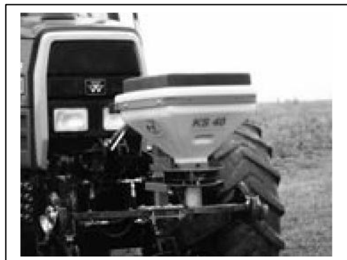
Fig. 2 KS40 monteret bagpå en plænetraktor
